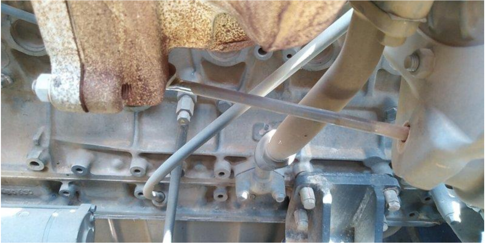
检查涡轮增压器旁通阀，未发现异常
